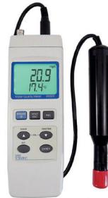
Las sondas intercambiables plug and play permiten que este medidor versátil lea pH, mV, ORP, conductividad, salinidad, TDS, DO y temperatura.
