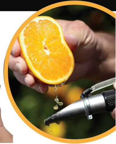
**Refractómetro para azúcar 0-80% Brix**
