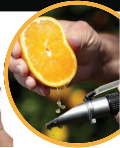
Refractómetro para azúcar 0-80% Brix
